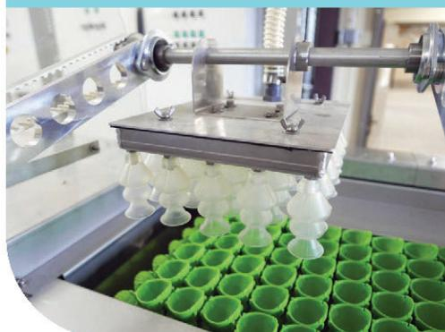
← D'une conception très simple basée sur une ossature en inox et un fonctionnement essentiellement mécanique, l'emballuse V-Pack 70 se caractérise par un bras de transfert équipé de 30 ventouses conditionnant les œufs par plateau de 30 unités avant d'être pris en charge par le robot Junior. Sa fiabilité permet à l'éleveur de se concentrer sur la table de tri à tubes rotatifs.
