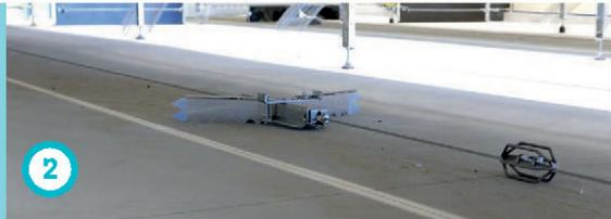
Mis au point par un éleveur alsacien et adapté par Fienhage, un système de tension automatique (1) réajuste la pression du câble lors du mouvement retour des poulies des racleurs (2). Serupa propose cette option depuis 1 an.
