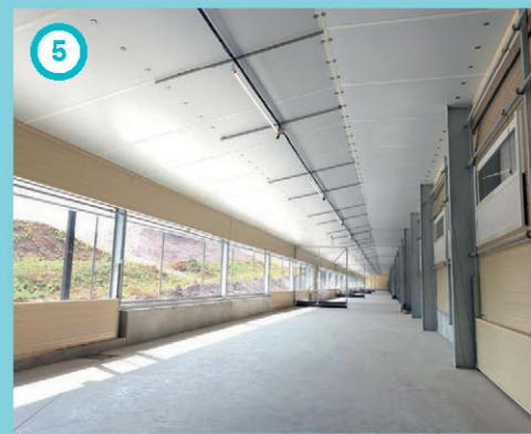
D'une superficie de 1030 m<sup>2</sup>, les deux jardins d'hiver sont équipés de châssis fixes et de volets roulants électriques. Le plafond est recouvert de panneaux sandwich afin que les pannes ne soient pas apparentes et que la surface soit plus hygiénique (13). À l'extérieur, les panneaux occultants participent à l'intégration paysagère (14).
